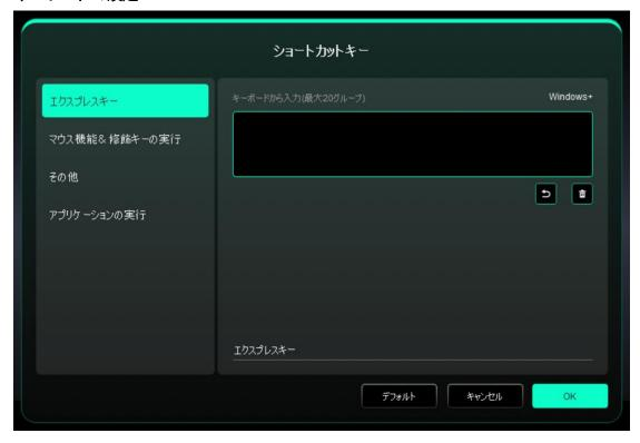
キーボードのショートカットキーは設定可能です。例えば、3D MAX では「Alt+A」に設定すると、位置合わせツールを使用できます。
