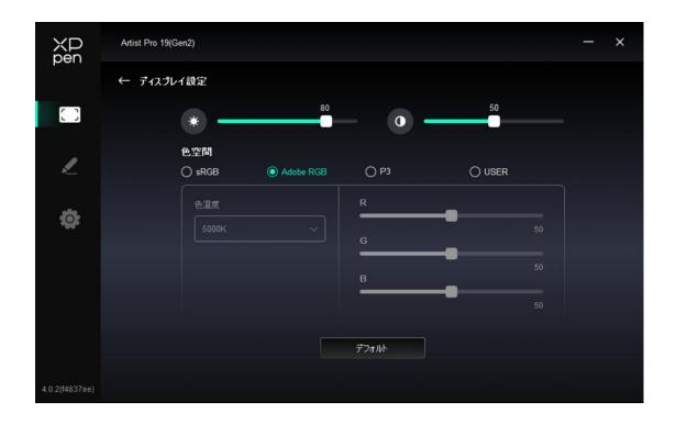
輝度、コントラスト比:対応するスライダーをスライドさせて、輝度とコントラスト比を 調整します。
